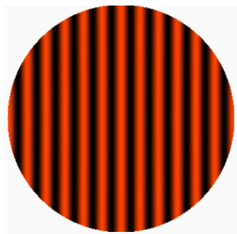
FIGURE 14 – Figure d'interférence obtenue en coin d'air ( \alpha = 77 \mu\text{rad} , \lambda_0 = 633 \text{ nm} ) https://xyod.github.io/anim-ophy/Michelson/
