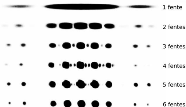
FIGURE 1 – Figures obtenues par passage d'un laser au travers de 1 à 6 fentes.
