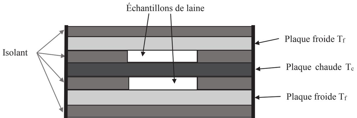
**Figure 2** - Principe de la plaque chaude gardée
