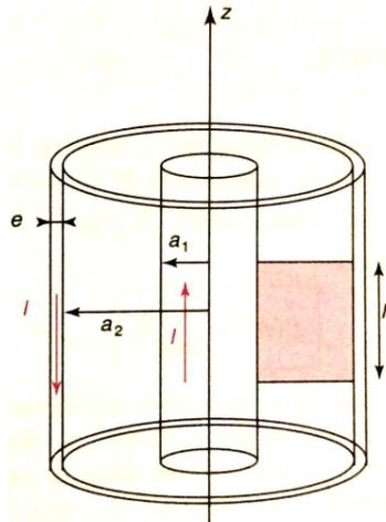
Ce câble est utilisé dans un circuit électrique : l'âme est alors parcourue par un courant  $I$  réparti uniformément dans son volume, tandis que la gaine est parcourue par un courant  $-I$  réparti sur sa surface (l'épaisseur est négligée).
