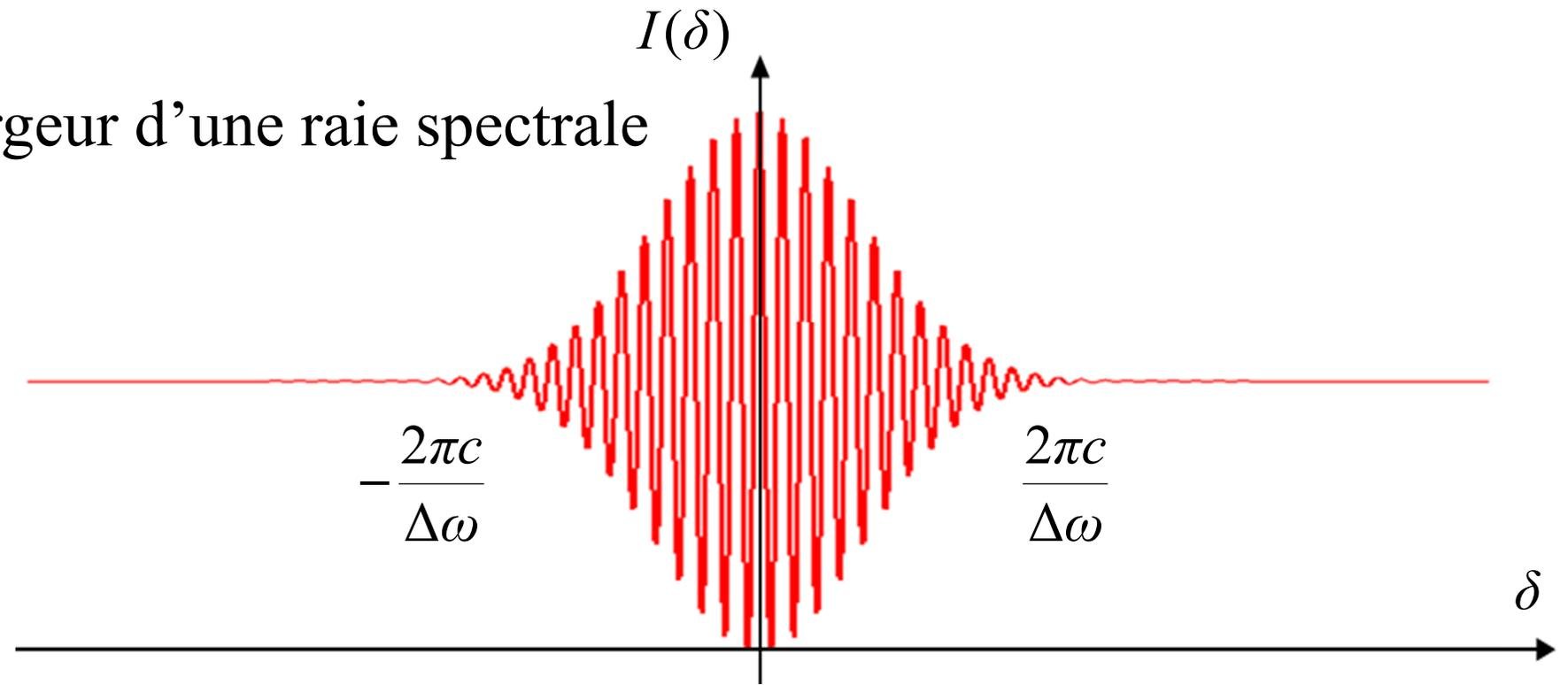
Les franges sont visibles pour  $|\delta| < \ell_c \sim \frac{2\pi c}{\Delta\omega} = \frac{\lambda_m^2}{\Delta\lambda}$  soit  $e < \frac{\ell_c}{2} \sim \frac{\pi c}{\Delta\omega} = \frac{\lambda_m^2}{2\Delta\lambda}$ .
