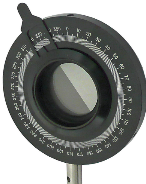
Un analyseur à pénombre utilisé en TP : il ressemble à un polariseur, mais on distingue la séparation en deux demi-disques.
