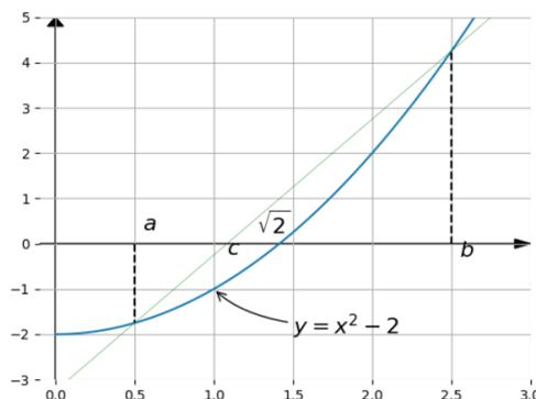
Si  $f(c)$  est du même signe que  $f(a)$ , on pose  $a_1 = c$  et  $b_1 = b$ , sinon on pose  $a_1 = a$  et  $b_1 = c$ . En itérant le processus, on construit comme dans la méthode par dichotomie des suites  $(a_n)$ ,  $(b_n)$  et  $(c_n)$ .
