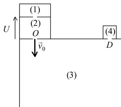
Dans la chambre d'ionisation (1), on produit des ions  $\text{Zn}^{2+}$  de masse  $m$  et de charge  $q = 2e$ . Ces ions pénètrent avec une vitesse négligeable dans une enceinte accélératrice (2), où règne un champ électrique créé par une tension  $U$  entre les deux plaques limitant (2). Ils en sortent en  $O$  avec une vitesse  $\vec{v}_0 = v_0 \vec{e}_x$ , et pénètrent alors dans l'enceinte (3) où règne un champ magnétique uniforme  $\vec{B}$  orthogonal au plan de figure.
