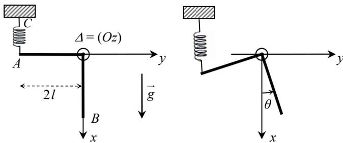
On donne le moment d'inertie d'une tige de masse  $m$  et de longueur  $2l$ , par rapport à un axe perpendiculaire à la tige et qui passe par une extrémité :  $J_1 = \frac{4}{3} ml^2$ .
