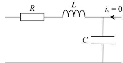
Filtre RLC série avec sortie sur C
