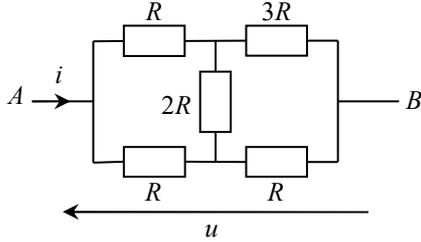
En utilisant les lois de Kirchhoff, déterminer la résistance équivalente de ce dipôle, c'est-à-dire une relation  $u = R_{\text{eq}} i$ .
