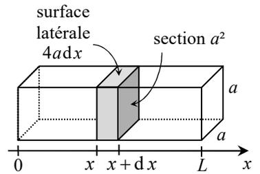
c) En régime stationnaire, l'équation devient :  $a \lambda \frac{d^2 T(x)}{dx^2} - 4h [T(x) - T_0] = 0$  ou encore  $\frac{d^2 T(x)}{dx^2} - \frac{1}{\delta^2} T(x) = -\frac{1}{\delta^2} T_0$  avec  $\delta = \sqrt{\frac{4h}{a\lambda}}$ .
