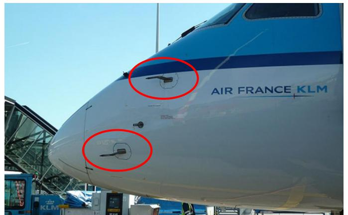
C'est un dispositif de mesure de vitesse présent notamment sur les avions : la mesure de pression en deux points différents ( $B$  et  $D$  sur le schéma) permet d'obtenir la vitesse  $v_\infty$  de l'écoulement loin en amont du tube.
