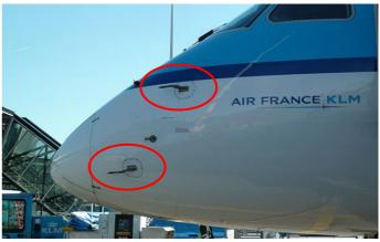
C'est un dispositif de mesure de vitesse présent notamment sur les avions : la mesure de pression en deux points différents (B et D sur le schéma) permet d'obtenir la vitesse  $v_{\infty}$  de l'écoulement loin en amont du tube.
