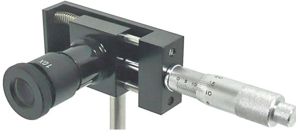
L'oculaire de Fresnel comporte une petite plaque transparente marquée d'un réticule (croix), et une ou plusieurs lentilles convergentes permettant d'observer le plan du réticule avec un fort grossissement. L'ensemble peut être translaté latéralement avec précision, à l'aide d'une vis micrométrique. Si on forme une image sur le réticule, on peut ainsi mesurer précisément ses dimensions (ici l'interfrange de la figure d'interférences).
