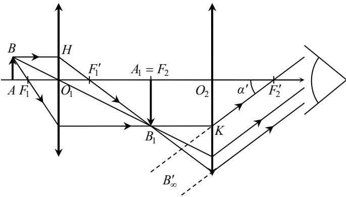
Le rayon le plus facile à tracer est en fait celui passant par  $F_1$  : il sert de rayon auxiliaire pour les deux autres.
