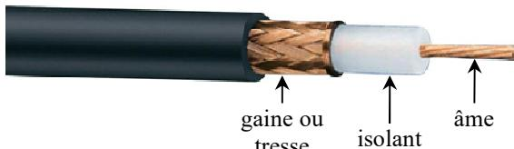
Entre les deux conducteurs, la capacité par unité de longueur du câble est  $\gamma = 97 \text{ pF} \cdot \text{m}^{-1}$ . Et le câble possède également une inductance par unité de longueur  $\lambda = 0,23 \text{ } \mu\text{H} \cdot \text{m}^{-1}$ .
