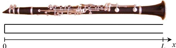
Lorsqu'on joue une note, une onde stationnaire s'établit dans le tuyau ; une petite partie de l'énergie de cette onde est transmise à l'extérieur, mais la pression acoustique pour  $x > L$  a une amplitude très faible devant celle à l'intérieur du tube.
