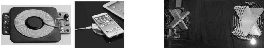
FIGURE 2 – À gauche : couplage inductif non résonant en champ proche ; à droite : couplage inductif résonant en champ proche.
