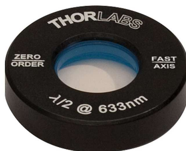
Lame demi-onde (pour \lambda = 633 \text{ nm} )
