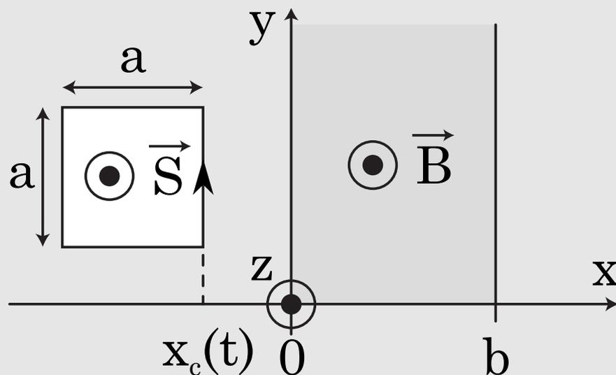
Le flux du champ magnétique à travers le cadre se calcule aisément, la surface de champ non nul étant un rectangle de côtés  $a$  et  $x_c$  et le champ étant uniforme sur cette surface :  $\varphi = \vec{B} \cdot ax_c \vec{e}_z = Bax_c$ .
