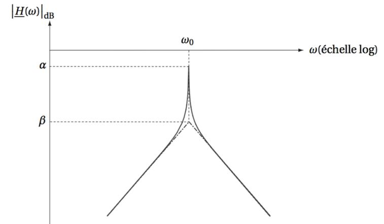
Identifier les valeurs de  $\alpha$  et  $\beta$ . Quelles sont les pentes des asymptotes? Quelle est l'allure de diagramme de BODE en phase?
