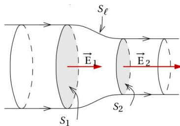
La conséquence est la suivante : l'évasement des tubes de champ électrostatique loin des sources traduit une diminution de l'intensité de ce champ.
