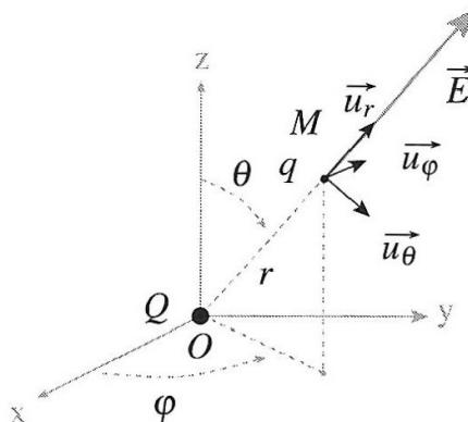
**Définition :** La charge ponctuelle  $Q$  placée en  $O$  crée en un point  $M$  situé à la distance  $r$  de  $O$  le champ électrostatique :
