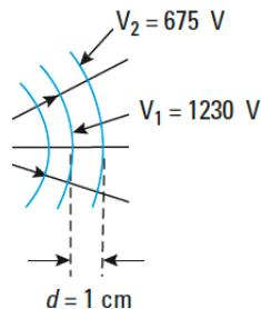
J'ai reproduit une partie d'une carte de champ (voir ci-dessous) en y ajoutant l'échelle d'espace et deux valeurs du potentiel  $V$ . Nous pouvons calculer une valeur moyenne du champ en évaluant le gradient de potentiel entre les équipotentielles  $V = V_1$  et  $V = V_2$  :  $E \approx \frac{V_1 - V_2}{d} \approx 55,5 \text{ kV.m}^{-1}$ .
