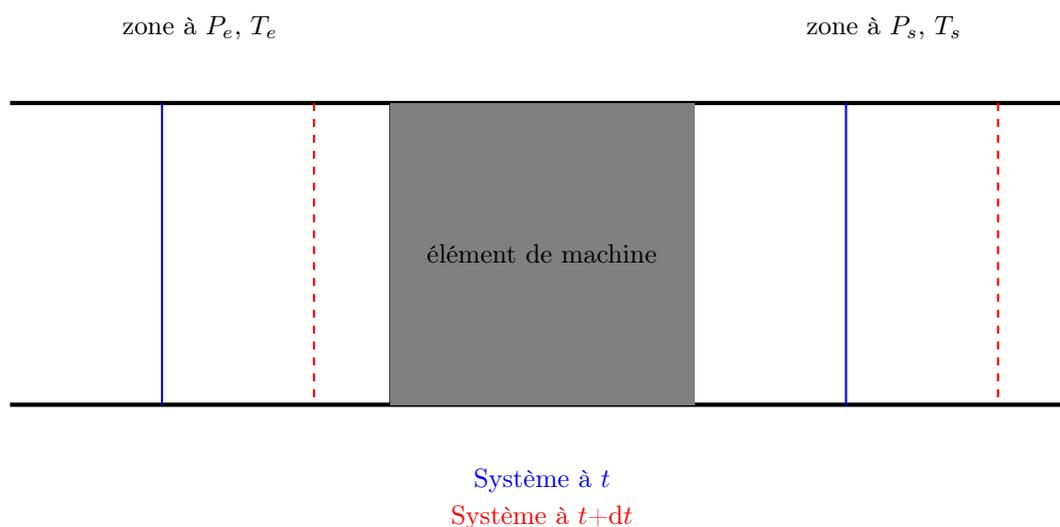
Le principe est donc d'estimer la masse, l'énergie interne ou l'entropie du système entre les parois à  $t$  (parois solides) et à  $t + dt$  (parois pointillées).
