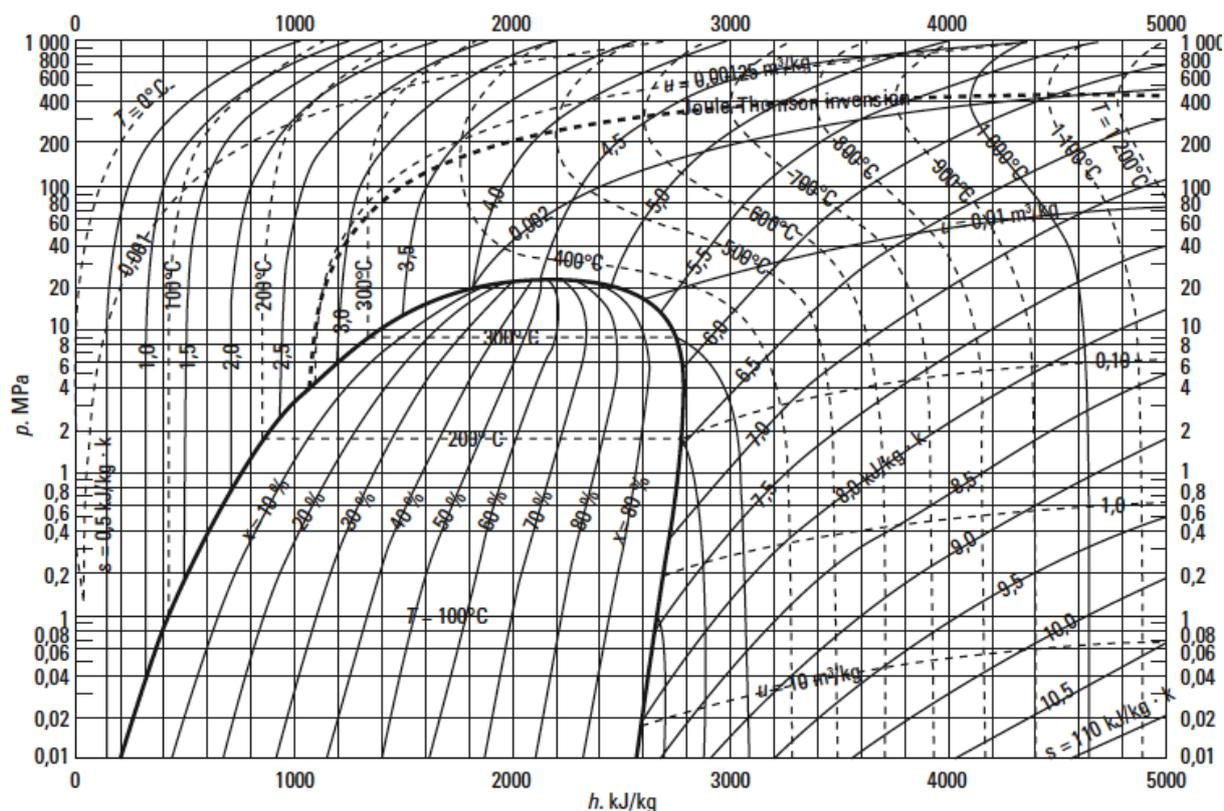
On donne ci-dessus l'exemple du diagramme enthalpique de l'eau. Dans ce diagramme sont représentées la courbe d'ébullition et la courbe de vapeur saturante. La zone liquide est située dans la partie gauche du diagramme et la zone vapeur est située dans la partie droite. Au centre, sous la courbe de saturation, se situe la zone du mélange liquide-vapeur.
