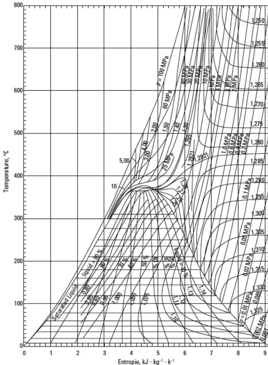
On donne ci-dessus l'exemple du diagramme entropique de l'eau. Dans ce diagramme sont représentées la courbe d'ébullition et la courbe de rosée. Comme pour le diagramme enthalpique, la zone liquide est située dans la partie gauche et la zone vapeur est située dans la partie droite. Au centre, sous la courbe de saturation, se situe la zone du mélange liquide-vapeur.
