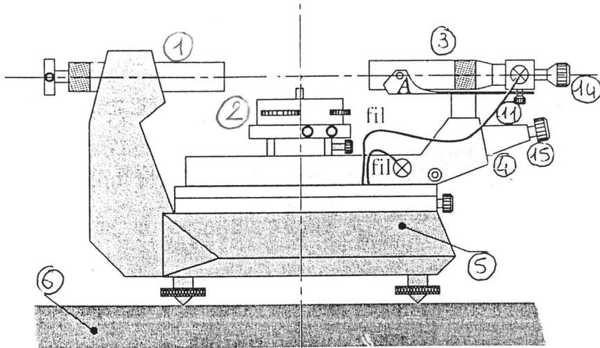
Éléments principaux d'un goniomètre de précision.
