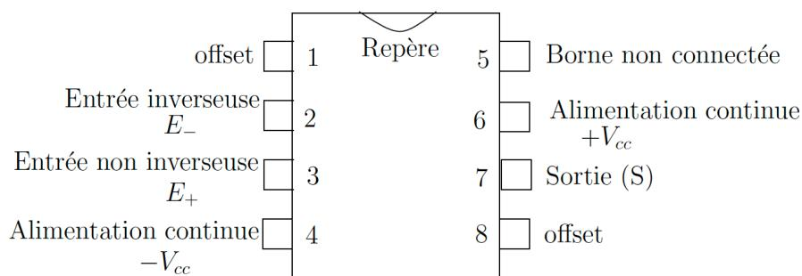
Ces connexions de base restent en place jusqu'à la fin de la séance. Les bornes (1), (5) et (8) ne seront pas utilisées.
