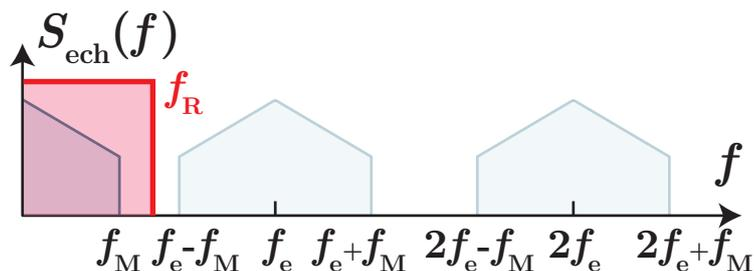
Cependant, si la fréquence d'échantillonnage est mal choisie, c'est-à-dire si le signal est sous-échantillonné, on observera un enrichissement du spectre de  $s_{ech}(t)$  :
