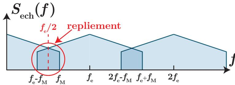
Le signal échantillonné contient, même en dessous de sa fréquence maximale  $f_M$ , des composantes qui ne sont pas présentes dans le signal initial. On dit qu'il y a *repliement* du spectre, ou en anglais *aliasing*.
