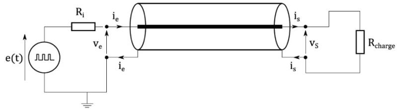
La tension est appliquée entre les deux conducteurs, et le courant circule en sens inverse dans les deux conducteurs. Comme on étudie la propagation de signaux électriques, on ne se place pas dans le cadre de l'ARQS. On note alors  $i(x,t)$  et  $u(x,t)$  la tension et le courant à une abscisse  $x$  du câble :
