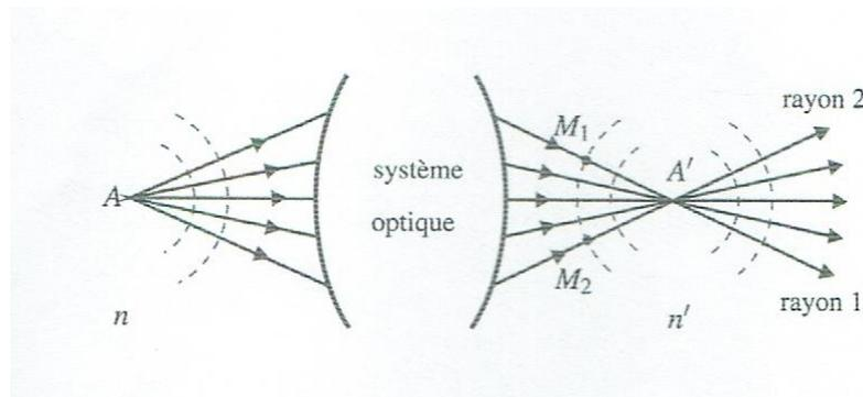
Avant le système optique, les rayons sont des droites passant par  $A$ . D'après le théorème de Malus, les surfaces d'onde sont des sphères de centre  $A$ .
