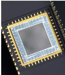
Le capteur CCD est composé d'une suite de petites photodiodes placées les unes contre les autres, et se présente souvent sous la forme d'une barrette ou d'une zone rectangulaire. Les électrons excités par l'arrivée d'énergie sur une photodiode sont ensuite détectés photodiode après photodiode pour reconstruire une image. On trouve des capteurs CCD dans les caméras ou les appareils photos numériques.
