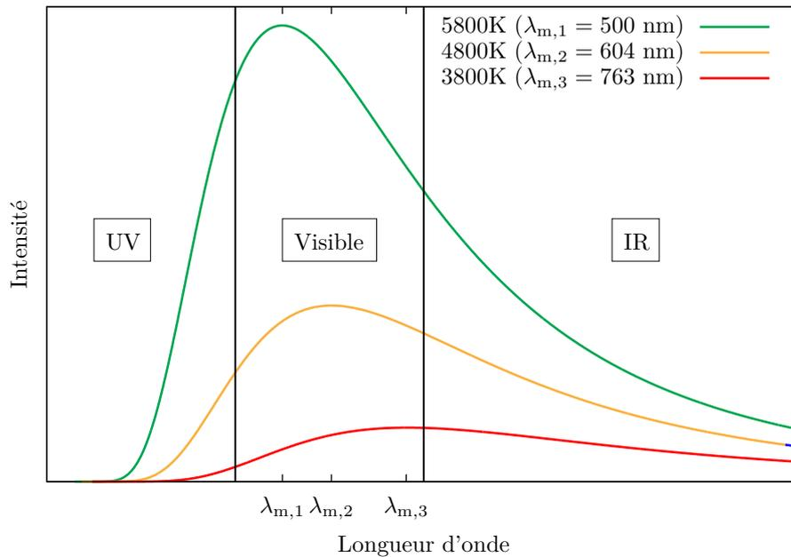
Par exemple, le filament d'une ampoule à filament est chauffé par effet Joule à 2500 K environ. Le maximum d'émission est donné par la loi de Wien :
