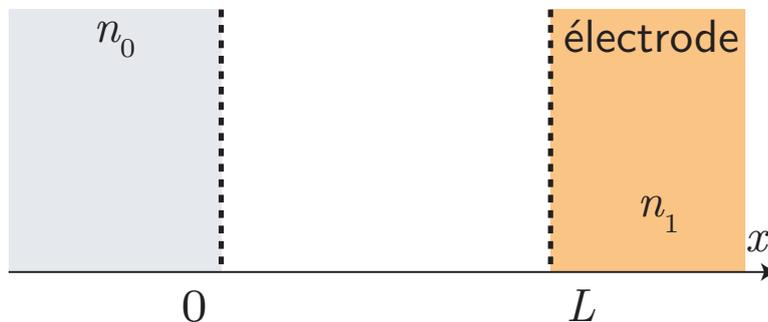
En régime quasi-stationnaire (l'évolution des densités particules  $n_0$  et  $n_1$  est supposée lente devant le temps caractéristique de diffusion), la densité particulaire doit vérifier l'équation  $\frac{d^2 n}{dx^2} = 0$ , c'est-à-dire que :
