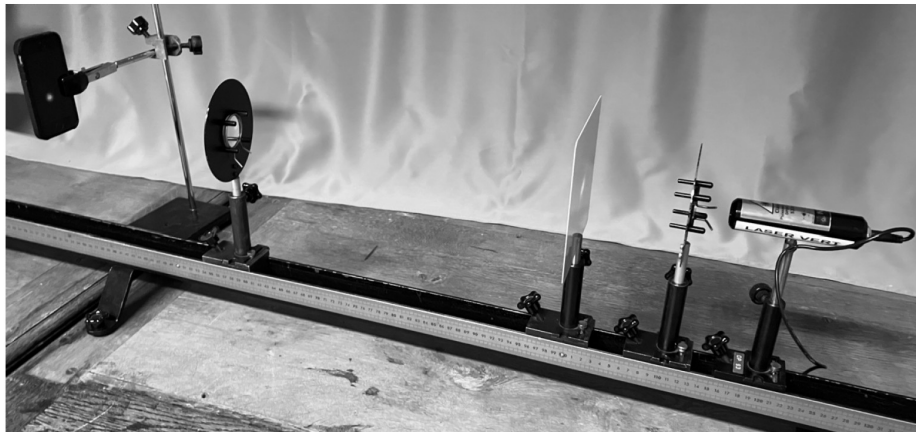
Figure 9 Dernier montage : détermination de la taille d'un pixel
