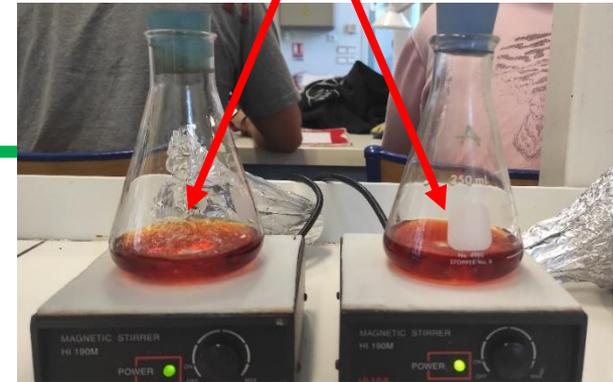
Réaction 1 : addition de ICl(aq) sur les doubles liaisons des acides gras
