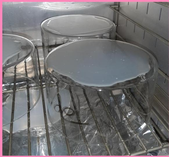
Plastique réparti sur le dessous des cristallisoirs dans l'étuve à 110°C
