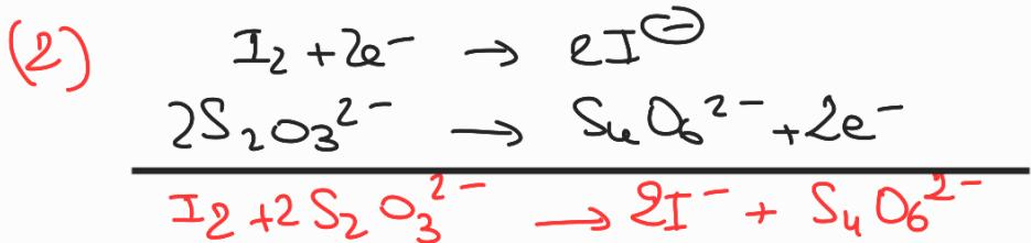
Il s'agit d'un dosage en retour car on dose l'électrode  $\text{I}_2$ :
