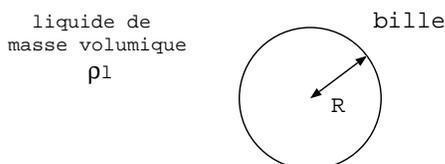
♥ C'est la résultante des forces de pression exercées par un fluide sur un objet. Cette force est verticale ascendante égale au poids du volume de fluide déplacé par l'objet.
