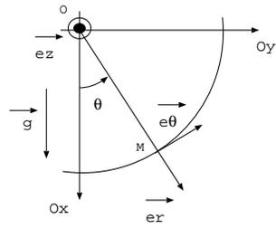
Etablir, par application du théorème du moment cinétique, l'équation différentielle vérifiée par  $\theta$  en présence de frottement fluide de la forme  $\vec{f} = -h\vec{v}(M)$ . On néglige les frottements solide.
