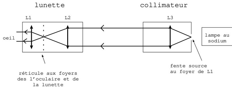
Le réglage du goniomètre consiste à régler le tirage des trois le lentilles  $L_1$  (oculaire),  $L_2$  (objectif) et  $L_3$  (collimateur). Le réglage se fait dans le sens inverse de la lumière.
