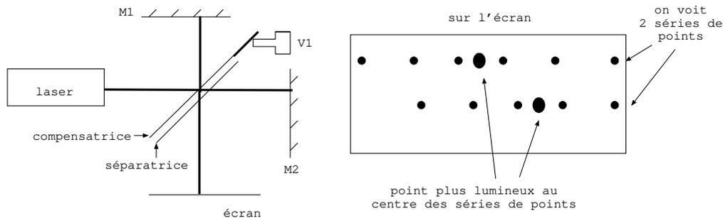
On observe sur l'écran deux séries de points lumineux. Chaque série de points comprend en son centre un point plus lumineux que les autres. Ces séries de points résultent des diverses réflexions sur les faces de la compensatrice et la séparatrice.
