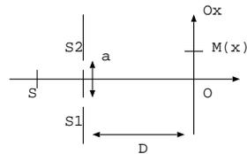
8. Dans l'expérience des trous d'Young, le système est éclairé par deux sources  $S$  et  $S'$  de même longueur d'onde. Sur deux schémas différents, montrer à quoi correspondent les différences de marche  $\delta_S(M) = (SS_2M) - (SS_1M)$  et  $\delta_{S'}(M) = (S'S_2M) - (S'S_1M)$  et donner sans calcul leurs expressions. Exprimer les valeurs de  $h = SS'$  pour lesquelles le contraste est nul.
