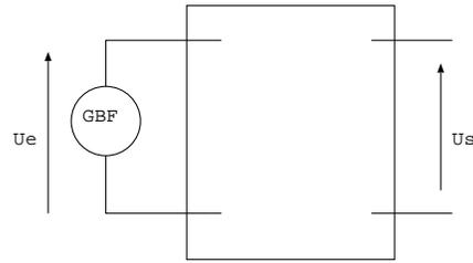
Les valeurs de  $S$  et de  $\phi$  dépendent de la fréquence, on trouve leur expression en utilisant la fonction de transfert définie par:  $\underline{H}(f) = \frac{U_s}{U_e}$
