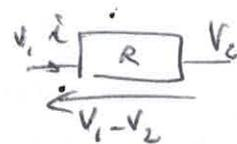
En thermique, par analogie, on a:  $T_1 - T_2 = R_{th} \times \Phi_{th}$
