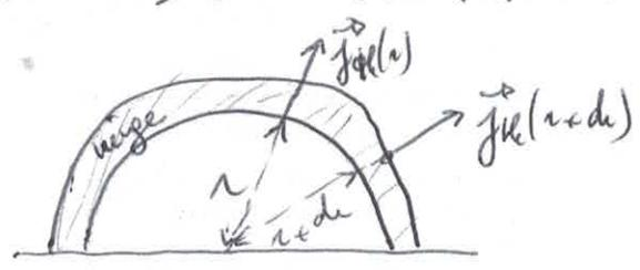
En régime stationnaire, la température de ce système est constante donc l'énergie thermique reçue est égale à l'énergie thermique perdue
