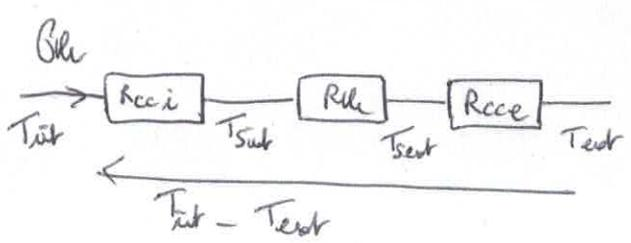
avec  $R_{ci} = \frac{1}{h_i 2\pi R_i^2}$ ,  $R_{ce} = \frac{1}{h_e 2\pi (R_i + L)^2}$  et  $R_{le} = \frac{L}{2\pi \lambda (R_i + L) R_i}$
