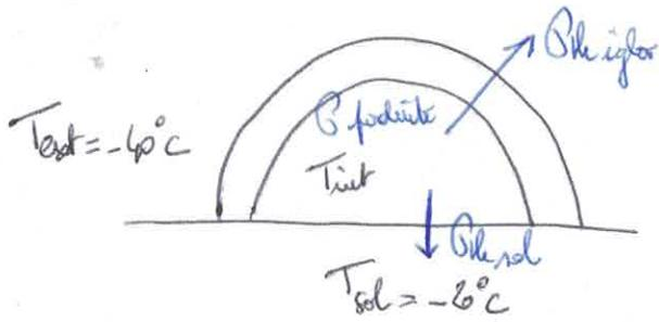
La température de l'air à l'intérieur de l'igloo est constante (régime stationnaire) donc la puissance reçue par l'air est égale à la puissance perdue par l'air :
