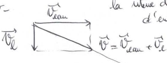
la vitesse des particules est la résultante des vitesses d'entraînement de l'eau et de la vitesse liée à la gravité : les particules décrittent une trajectoire rectiligne oblique dans la direction de  $\vec{V}$ .
