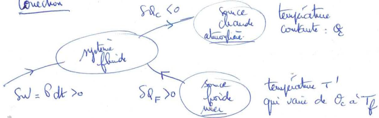
Q45. J'applique le 2<sup>nd</sup> principe au système fluide sur 1 cycle :
