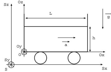
On note  $\mathcal{R}(S, \vec{e}_x, \vec{e}_y, \vec{e}_z)$ , le référentiel fixe lié au sol et supposé galiléen. On note  $\mathcal{R}'(O, \vec{e}_x, \vec{e}_y, \vec{e}_z)$ , le référentiel mobile lié au chariot.
