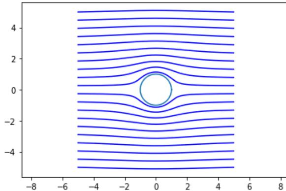
5. On donne  $(\vec{A} \cdot \vec{\text{grad}}) \vec{A} = \vec{\text{rot}} \vec{A} \wedge \vec{A} + \frac{1}{2} \vec{\text{grad}}(\vec{A}^2)$ . Ecrire l'équation de Navier Stokes et la simplifier avec les hypothèses données pour cet écoulement, en déduire que  $P + \frac{\rho v^2}{2}$  est une grandeur constante dans tout le fluide. Que peut-on dire de la pression aux points où la vitesse est minimale? où la vitesse est maximale?
