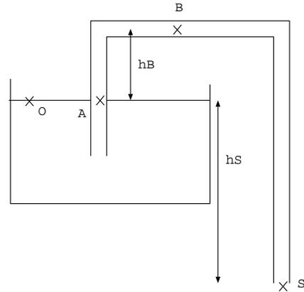
1. Calculer le débit maximal sans qu'il ne se produise de cavitation. On admettra que la cavitation apparaît lorsque on atteint une pression absolue nulle au point le plus haut de l'écoulement.
