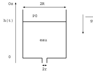
1. Tracer l'allure de quelques lignes de courant dans le réservoir. On note A un point à la surface de l'eau dans le réservoir et B le point dans le trou du réservoir sur la ligne de courant passant par A.
