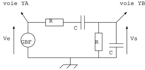
La fonction de transfert de ce filtre est de la forme  $H = \frac{V_s}{V_e} = \frac{H_0}{1 + jQ(\frac{\omega}{\omega_0} - \frac{\omega_0}{\omega})}$ . Dédurre de cette expression la nature du filtre. Que représentent  $\omega_0$ ?  $Q$ ?  $H_0$ ?
