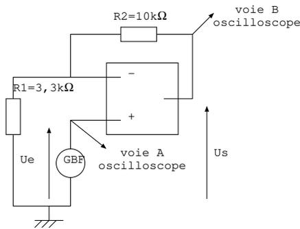
Observer les tensions d'entrée et de sortie (forme, amplitude, déphasage) et mesurer le rapport des amplitudes de la sortie sur l'entrée soit  $\frac{U_s}{U_e}$  lorsque le montage est alimenté par:
