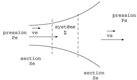
11.a. Montrer, en utilisant le système ouvert  $\Sigma$ , que les débits massiques à l'entrée et à la sortie sont égaux.
