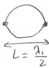
$$\text{soit } \lambda_1 = 2L = 1,26 \text{ m} \quad \left. \right) \text{ d'où } c = \lambda_1 f_1 = 240 \text{ m s}^{-1}$$
