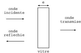
L'onde est partiellement réfléchi sur la vitre alors qu'une onde est transmise et se propage dans l'air après traversée de la vitre. On note les vitesses en représentation complexe:
