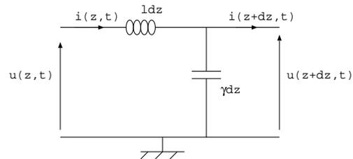
1.a. Déduire de la loi des noeuds, la relation entre  $\frac{\partial u}{\partial t}(z, t)$  et  $\frac{\partial i}{\partial z}(z, t)$ .
