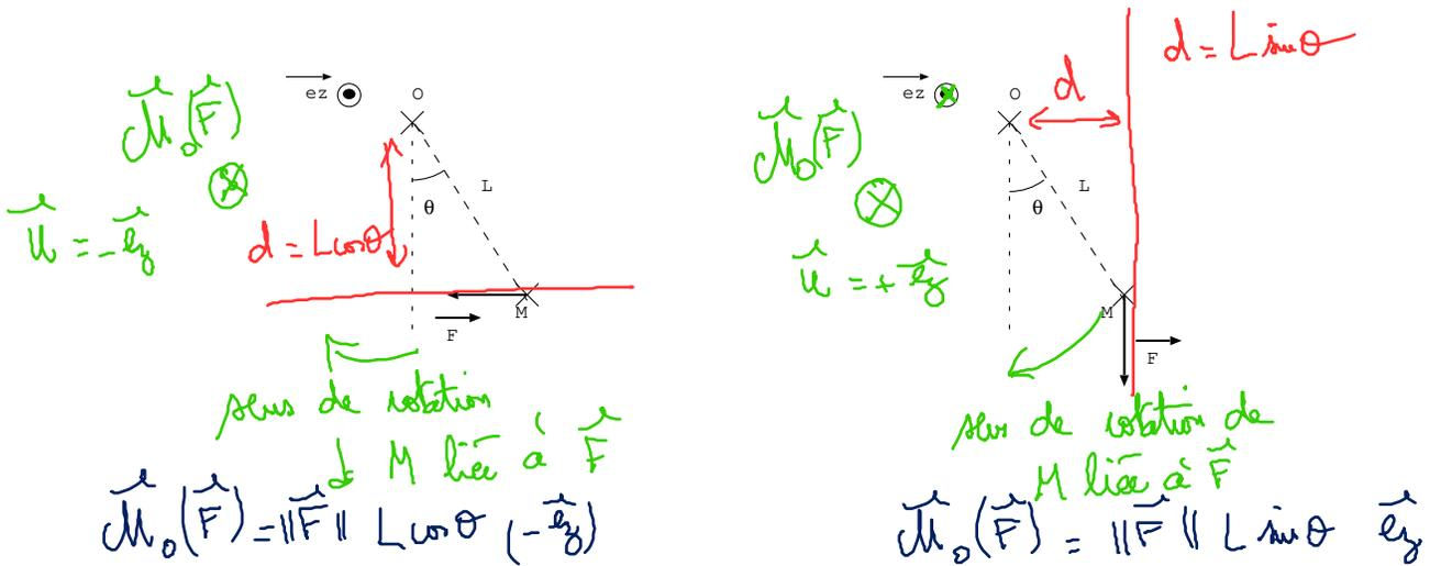
Cas particulier: pour des forces qui dépendent de la vitesse ou de la position, il peut être plus simple de calculer le moment de la force avec le produit vectoriel dans le système de coordonnées de l'étude.
