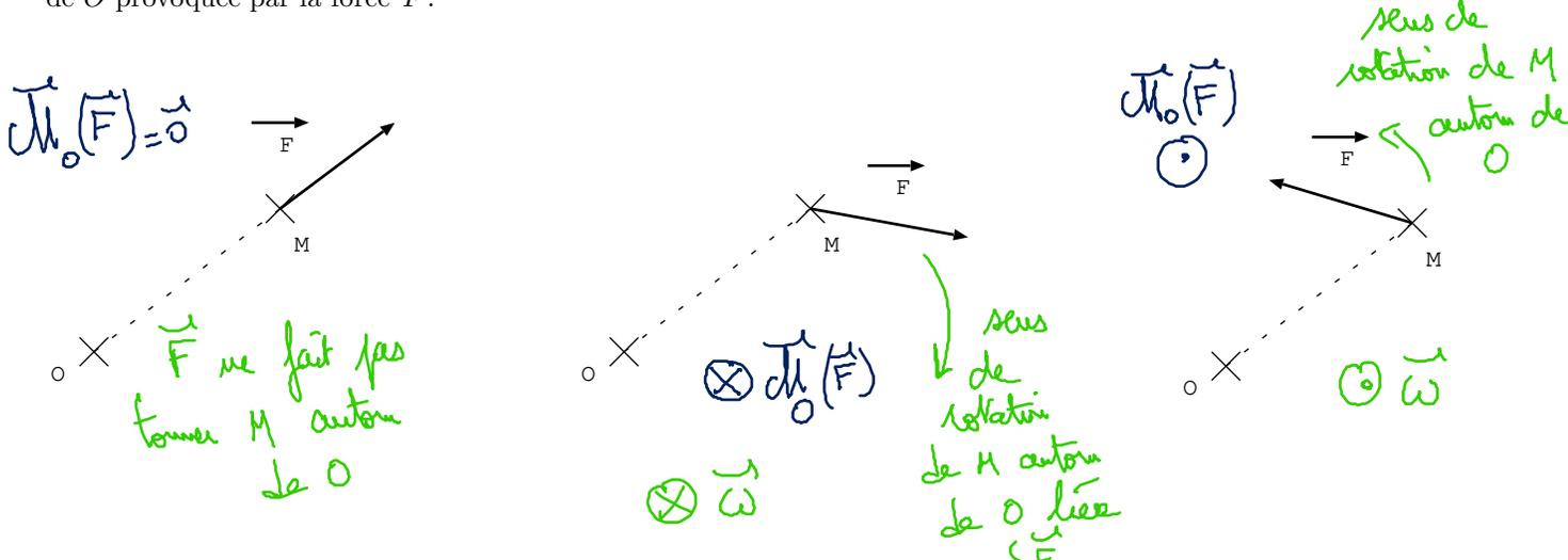
Le moment d'une force  $\vec{F}$  exercée sur  $M$  / à  $O$  est colinéaire de  $\vec{\omega}$  sens au vecteur rotation provoquée par  $\vec{F}$  sur  $M$  autour de  $O$ .
