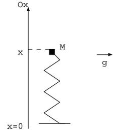
1. Dédurre du théorème de la puissance cinétique l'équation différentielle vérifiée par  $x$  et la mettre sous la forme  $\ddot{x} + \frac{\omega_0}{Q}\dot{x} + \omega_0^2 x = \omega_0^2 x_e$ .
