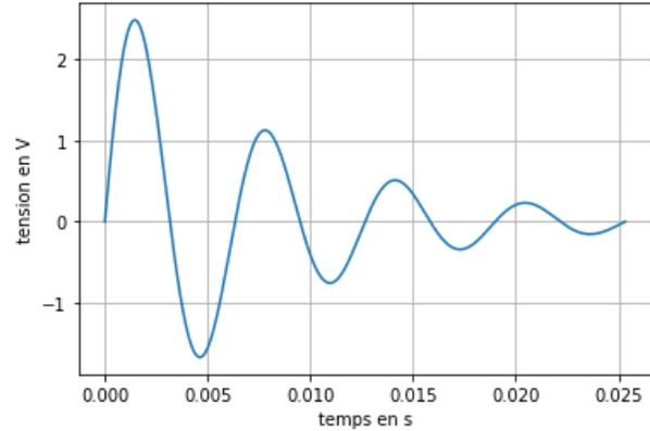
Réponses : 1-  $\frac{dU}{dt}(t = 0^+) = \frac{I_0}{C}$  2-  $\omega_0 = \frac{1}{\sqrt{LC}}$ ,  $Q = R\sqrt{\frac{C}{L}}$  3-  $\delta = \frac{\pi}{Q}$ ,  $Q = 4,5$ ,  $\omega_0 = 10^3 \text{ rad/s}$ ,  $C = 1,5 \mu\text{F}$  et  $L = 0,7 \text{ H}$
