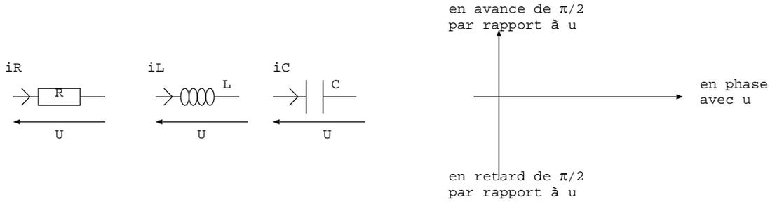
De même avec les notations suivantes, représenter les vecteurs associés à  $u_R$ ,  $u_L$  et  $u_C$  sur le schéma de droite.
