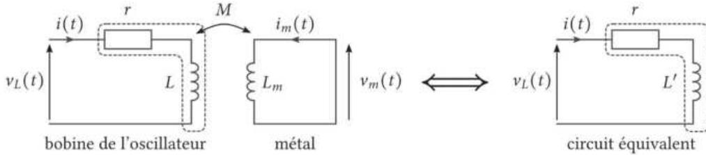
1. Montrer que  $v_L(t)$  se met sous la forme  $v_L(t) = ri + L' \frac{di}{dt}$  avec  $L' = L(1 - \frac{M^2}{LL_m})$ .
