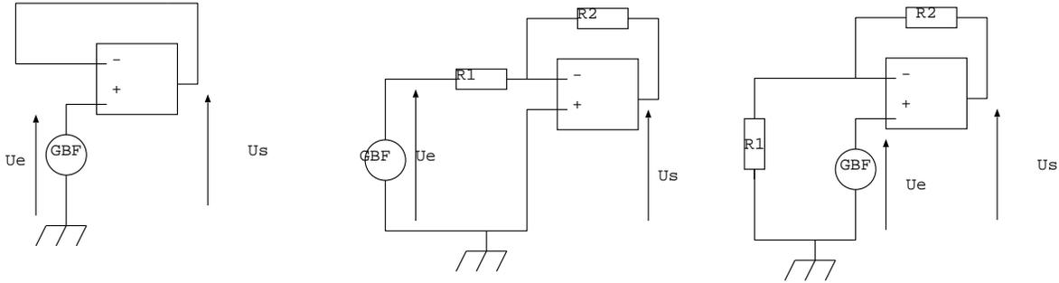
2. Montrer, en exprimant  $U_s$  en fonction de  $U_e$ , que le montage suivant est un montage intégrateur.
