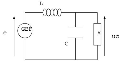
1. Représenter le circuit équivalent à BF et à HF et en déduire  $u_c(t)$  dans ces deux cas. Prévoir la nature du filtre.
