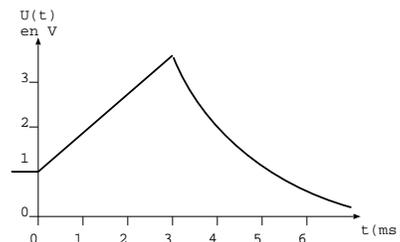
Réponses :  $u(t < t_1) = \frac{It + q_0}{C}$ ,  $U(t > t_1) = U_1 e^{-(t-t_1)/RC}$ ,  $C = 6.10^{-4} F$ ,  $R = 2,5 \Omega$ ,  $q_0 = 6.10^{-4} C$
