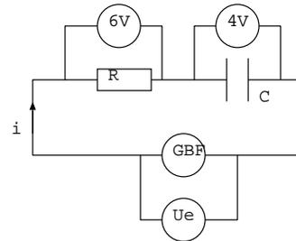
3. On donne les intensités lues sur des ampèremètres en mode AC. Utiliser un diagramme de Fresnel pour calculer l'intensité lue sur l'ampèremètre aux bornes de l'alimentation. Indice: faites un diagramme pour lequel l'axe des abscisses correspond aux signaux en phase avec  $u$  dans le circuit.
