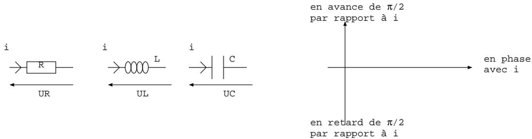
2. On donne les tensions lues sur des voltmètres en mode AC. Utiliser un diagramme de Fresnel pour calculer la tension lue sur le voltmètre aux bornes du GBF. Indice: faites un diagramme pour lequel l'axe des abscisses correspond aux signaux en phase avec  $i$  dans le circuit.
