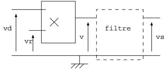
3. Sachant que l'on souhaite obtenir en sortie du filtre un signal permettant de déterminer la différence de fréquence  $f_d - f_r$  entre les oscillateurs, proposer un montage passif simple permettant d'isoler la composante pertinente du signal. Sachant que  $f_r \approx 7,5 \text{ kHz}$ , déterminer une valeur numérique plausible de sa fréquence de coupure.
