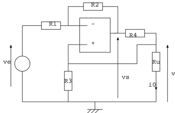
Réponses: 2-  $v = \frac{R_2v_e}{R_2 - \frac{R_1R_4}{R_3} - \frac{R_1R_4}{R_u}}$  3- pour  $R_1R_4 = R_3R_2$ , on a  $i_0 = -\frac{v_e}{R_3}$
